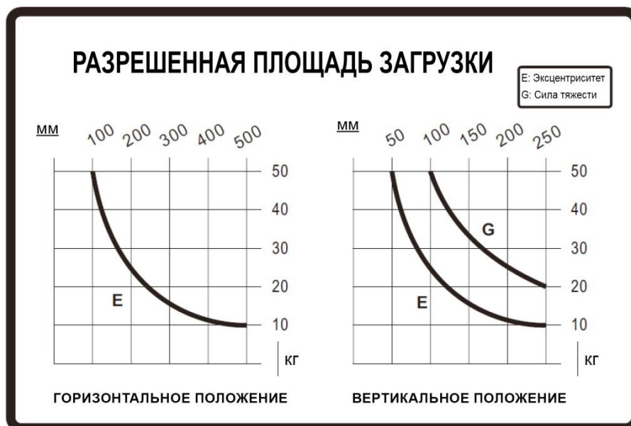
Рис. 1. Взаимосвязь расстояния эксцентриситета/центра тяжести и грузоподъемности рабочего стола
